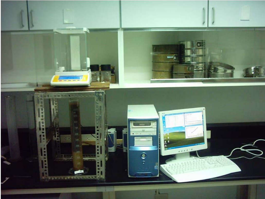
7. ábra: Mérleges kialakítású szemcseeloszlás-mérő műszer
